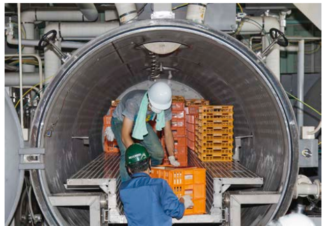
4 東日本大震災で水損した文書を真空凍結乾燥機に入れて乾燥させる
